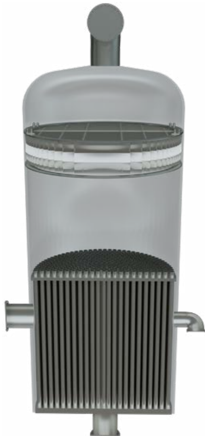
Imagem de renderização 3D de torre de cozimento.
