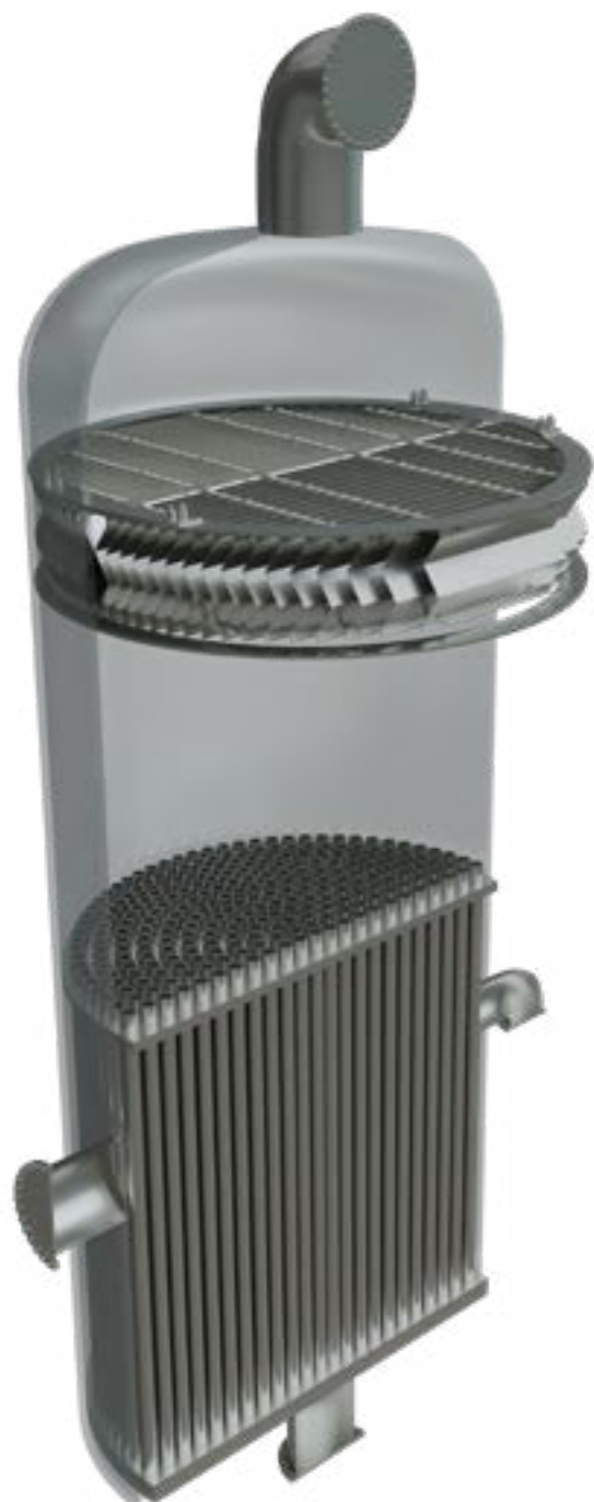
Imagem de renderização 3D de torre de evaporação.
