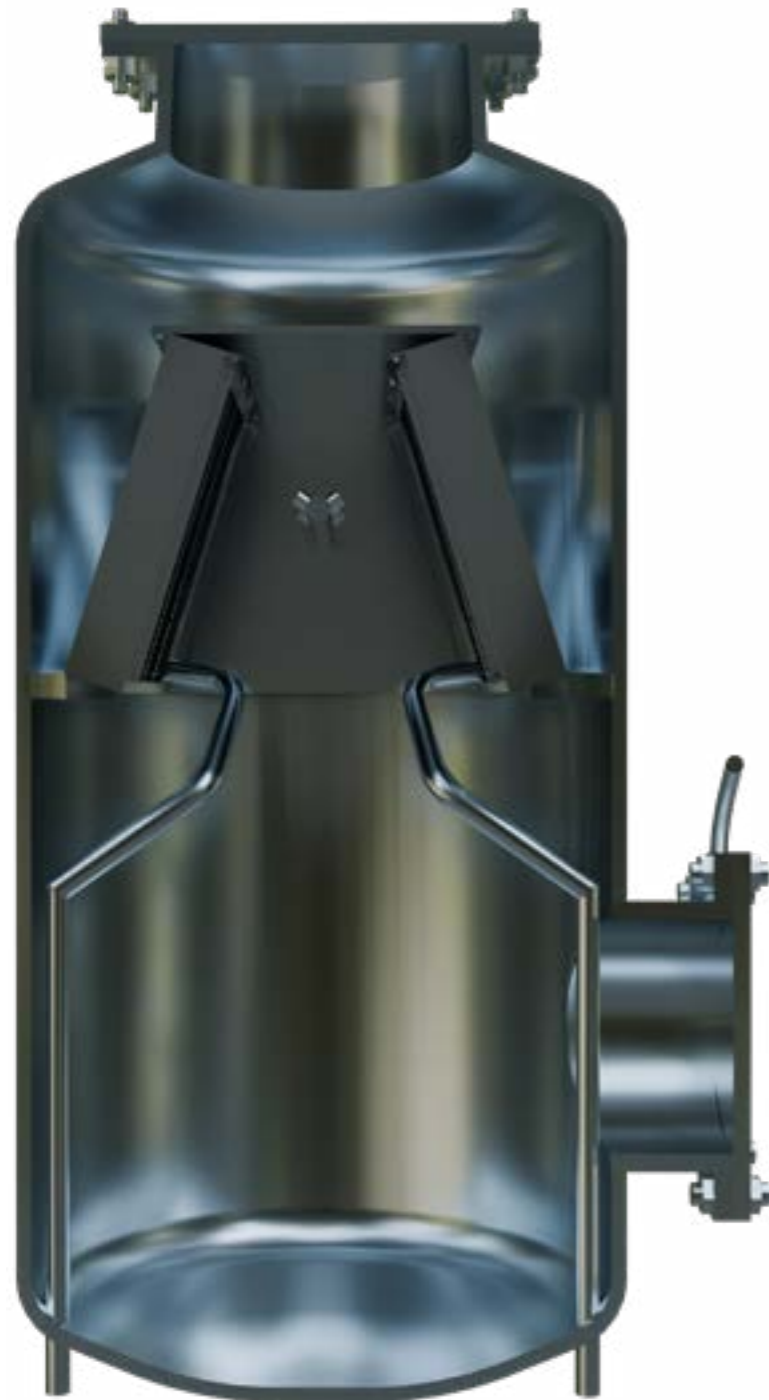
Imagem de renderização 3D do vaso para concentração de vinhaça.
